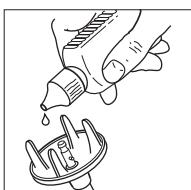
Bamix'en holder længere hvis den får olie hver anden måned. Der skal bruges syrefri olie (f.eks. vaselineolie som kan købes på apoteket). Hold bamix'en med bunden i vejret og tilfør akslen 2-3 dråber olie, hvorefter apparatet tændes i 2-3 minutter. Herefter rengøres apparatet i varmt vand.
