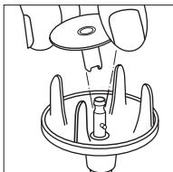
Sett arbeidsdelen loddrett på akselen slik at drivakslingen passer nøyaktig inn i skåret på drivakselen. Fjerning av arbeidsdelen foregår gjennom enkel uttrekking.
