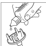
Smörj Bamix-apparaten regelbundet så håller den längre. Använd olja utan syra (tex. vaselinolja, som kan köpas på apotek). Håll bamix®-apparaten upp och ner, ge 2 – 3 droppar olja på drivaxelen och kör apparaten ca 2 – 3 min. Rengör sedan apparaten i hett vatten.
