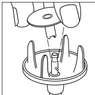
Montér arbejdsdelen lodret på akslen, således at den passer direkte i indskæringen på den påsatte del. Afmontering af delen sker ved at trække af. Brug evt. en klud som beskyttelse ved på- eller afmontering.
