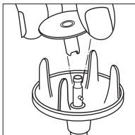
Työntäkää terä mahdollisimman pystysuorassa asennossa akseliin, siten että käyttööakselin tappi osuu tarkalleen terän uraan. Osa irrotetaan yksinkertaisesti vetämällä.
