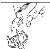
De bamix® blijft langer «fit» als u hem om de paar maanden met olie smeert. Gebruik daarvoor zuurvrije olie (bijv. vaselineolie die in de apotheek verkrijgbaar is). Houd de bamix® met de beschermkap naar boven, doe 2 à 3 druppels olie op de aandrijfas en schakel het apparaat ca. 2 à 3 minuten lang in. Reinig het apparaat daarna in heet water.
